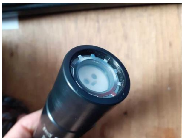
Фиг. 1. Логер за определяне на соленост и проводимост в океански води
