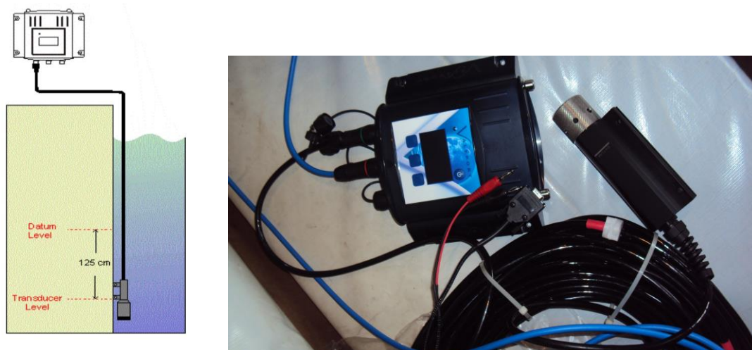
Фиг. 3. Принцип на действие на хидростатичен сензор и общ изглед
