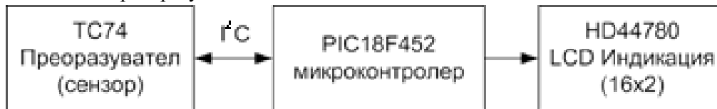
Фиг. 3. Блокова схема на микропроцесорната система
